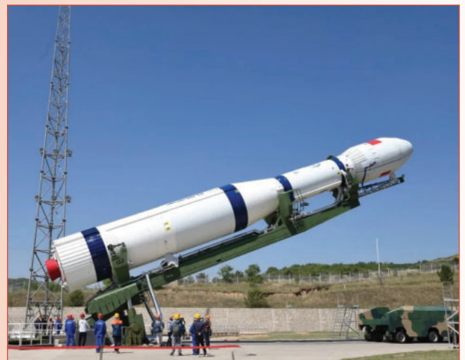
De Chang Zheng-6 wordt van haar trailer (rechts) overeind gezet op het lanceerplatform voor haar lancering op 20 juni. [CCTV]
