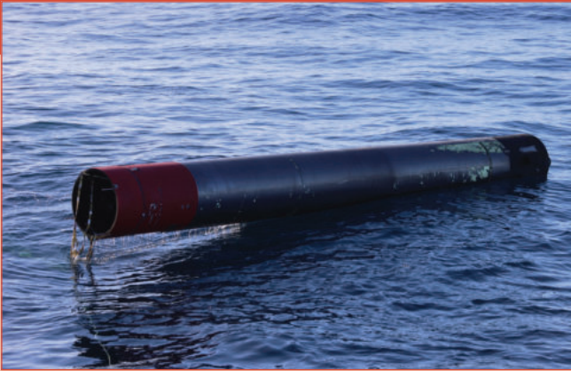
Rocket Lab bergt een eerste trap uit de Grote Oceaan na de lancering van de Electron raket op 18 juli. [Rocket Lab]
