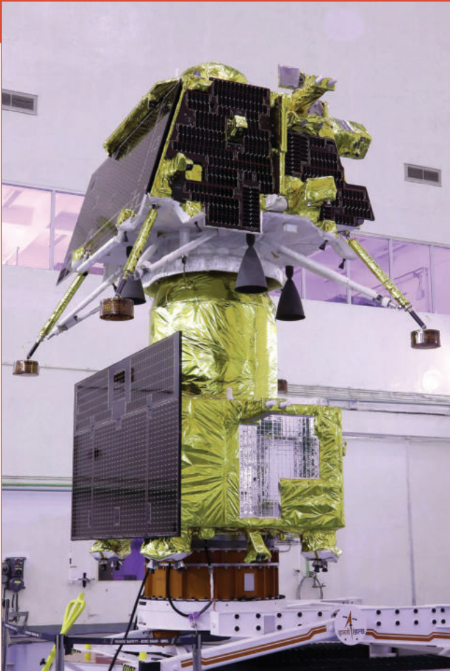
De Indiase maanlander Chandrayaan-3 in de cleanroom. De lander is bovenop een voortstuwingsmodule geplaatst die het geheel eerst in een baan om de Maan zal brengen. [ISRO]
