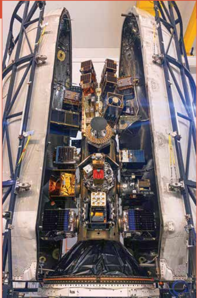
Maar liefst 72 satellieten vinden een plekje onder de neuskap van de Falcon-9 voor de Transporter-8 missie. [SpaceX]
