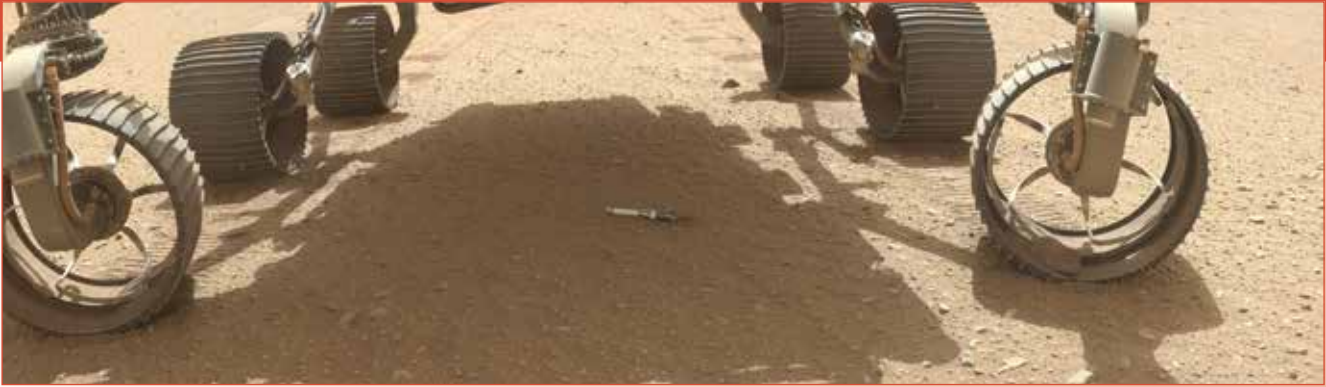
De Perseverance rover dropt de eerste van een serie bodemonsterbuisjes op het oppervlak. Begin jaren 2030 zullen deze buisjes opgehaald worden door een NASA/ESA missie en terug naar de Aarde worden gebracht voor gedetailleerde analyse in laboratoria. [NASA/JPL]
