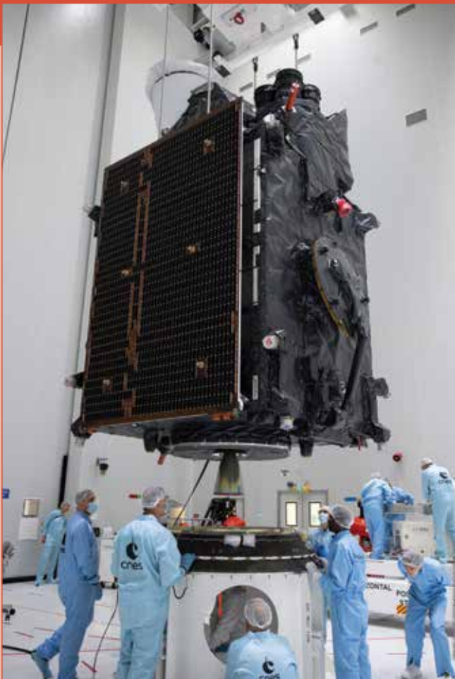
Links: de eerste satelliet van de derde generatie Meteosat satellieten, de MTG-I1, wordt op de adapter bovenop de Ariane-5 raket geplaatst. [ESA] Rechtsboven: op 5 december passeert Orion voor de tweede maal de Maan en begint aan de thuisreis. [NASA] Rechtsonder: Koelmiddel stroomt uit de lekke radiator van de Soyuz MS-22, mogelijk veroorzaakt door de inslag van een micro-meteoroid. [NASA TV]
