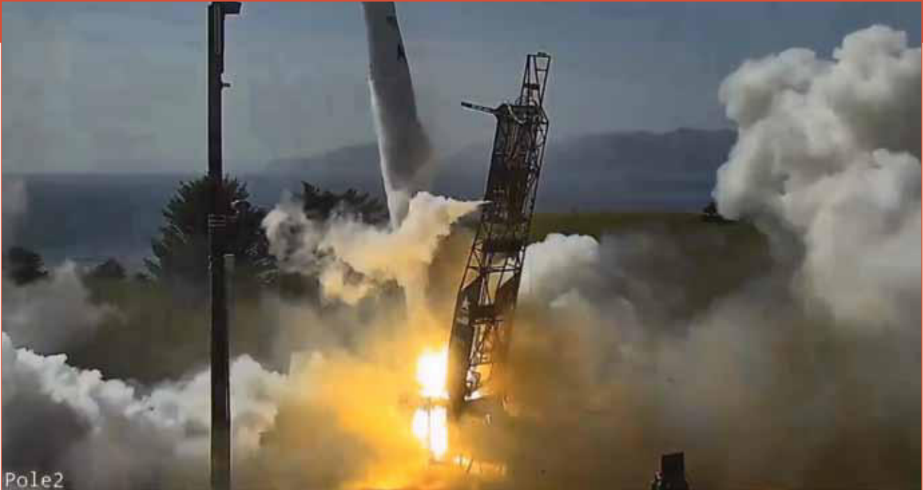
Als een van haar motoren uitvalt, vliegt de Astra raket bijna horizontaal weg van het startplatform tijdens de mislukte lancering op 29 augustus. [Astra]
