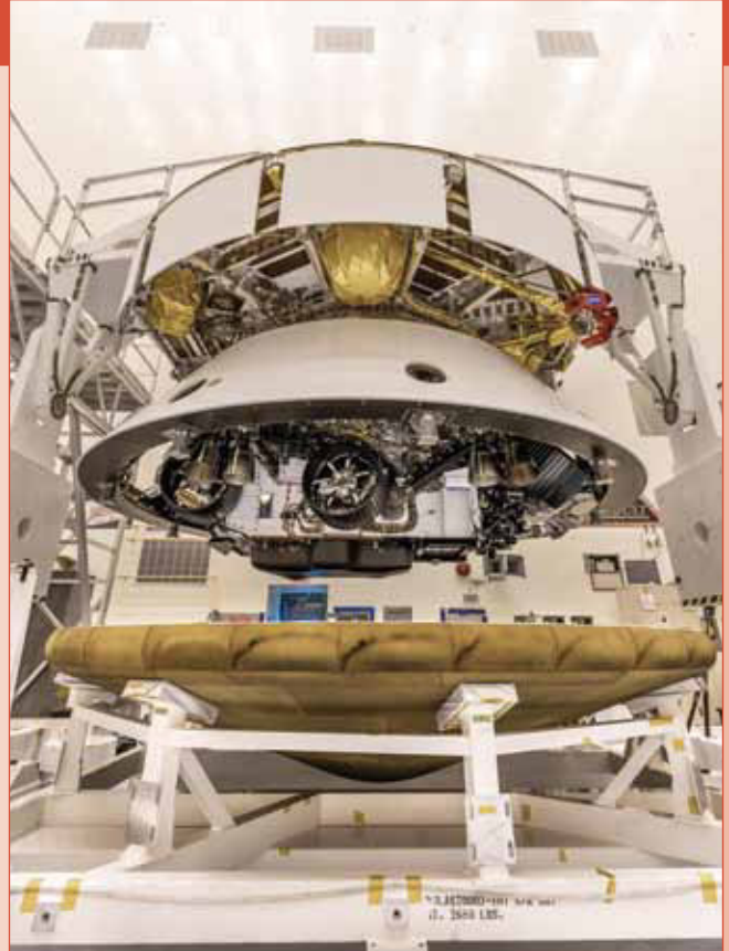
Onder: de Amerikaanse Marsrover Perseverance wordt in haar beschermende hitteschild geplaatst. Bovenaan is de cilindervormige cruise stage zichtbaar [NASA/JPL].
