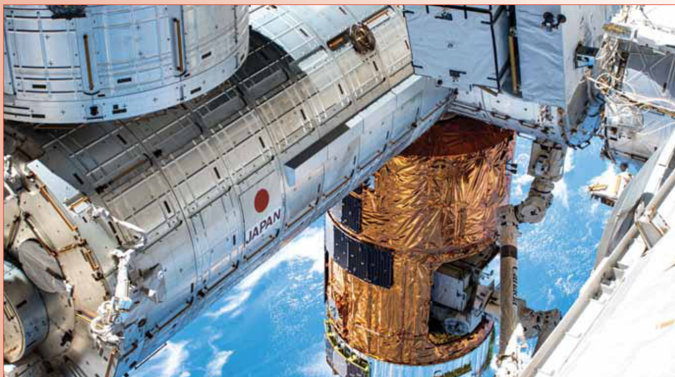
De robotarm Canadarm2 staat op het punt om de nieuwe batterijen voor de Amerikaanse zonnepanelen uit het vrachtruim van de aangekoppelde goudkleurige HTV-9 te halen. [NASA]
