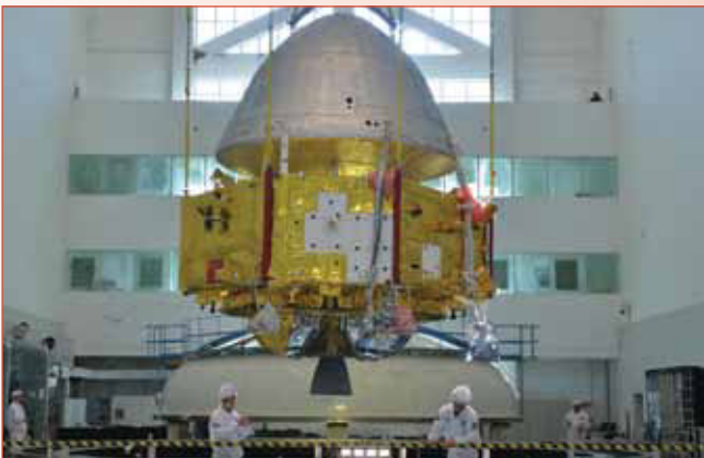
Boven: technici op een tijdelijk werkplatform onder het lanceerplatform in Baykonur tijdens de installatie van de Soyuz raket die de Progress MS-15 zal lanceren [Roscosmos]. Onder: China's eerste Marsmissie Tianwen-1 in de assemblagehal. Boven op de met goudkleurige dekens bedekte orbiter is het witte afdaaldeel met daarin een stationaire lander en een rover. [CASC]
