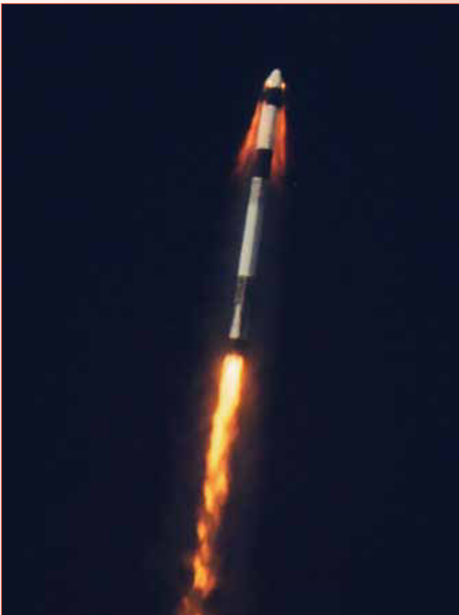
Tijdens de test op 19 januari, op een hoogte van 19 km, activeert de Crew Dragon haar ontsnappingsraketten. [SpaceX]
