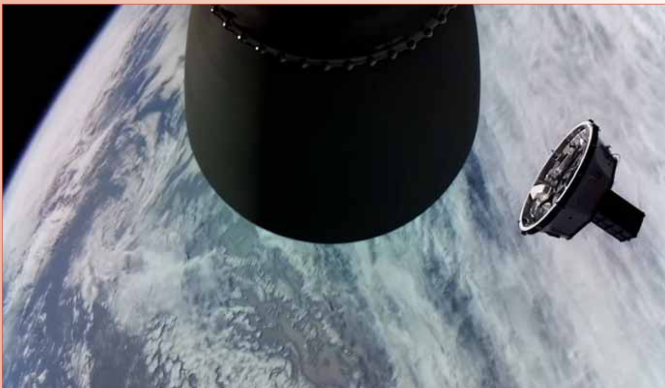
Rechts de bovenste trap, Curie genaamd, met de Palisade CubeSat, gefotografeerd vanuit de tweede trap van de Electron raket. [Rocket Lab]
