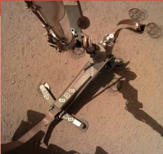
De robotarm van de Mars InSight verplaatst de Heat Probe om het vastlopen van de boorhamer van het experiment beter te kunnen onderzoeken. [NASA/JPL]
