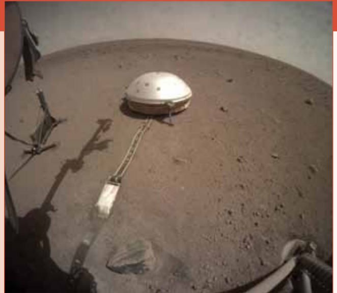
De Mars InSight heeft inmiddels de seismometer (rechts) en de HP 3 boorhamer (links) op het oppervlak geplaatst. Door rotsen onder het oppervlak heeft de HP 3 boor nog niet de gewenste diepte van 3 m kunnen bereiken. [NASA/JPL-Caltech]
