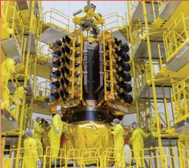
De vier O3b satellieten, gemonteerd op hun centrale adapter, tijdens de laatste voorbereidingen voor hun lancering. [ArianeSpace]
