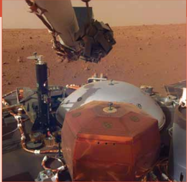
Het instrumentendek en een deel van de omgeving van de Insight lander op Mars. Het koperkleurige object op de voorgrond is het Franse seismologie-experiment. [NASA/JPL]
