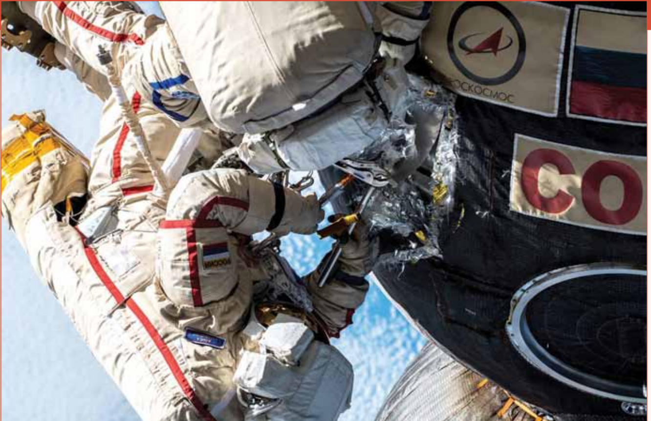
Ruimtetwandelers Kononenko en Prokopen verwijderen isolatiedekens om toegang te krijgen tot de locatie van het lek in de baanmodule van de Soyuz MS-9. [NASA/EVA]
