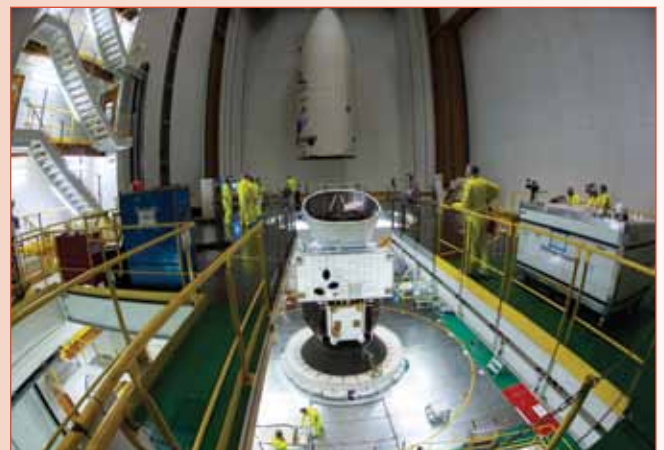
Acht dagen voor de lancering plaatsen technici de neuskap over de Mercurius-sonde BepiColombo. Van onder naar boven zijn achtereenvolgens de Mercury Transfer Module (MTM), de Mercury Planetary Orbiter (MPO) en de Japanse Mercury Magnetospheric Orbiter (MMO) te zien. [ESA]
