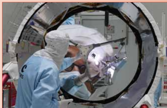
Een technicus voert tijdens de voorbereidingen op de lanceerbasis Kourou een laatste inspectie uit van de 1,5 meter telescoop van Aeolus. [ESA]
