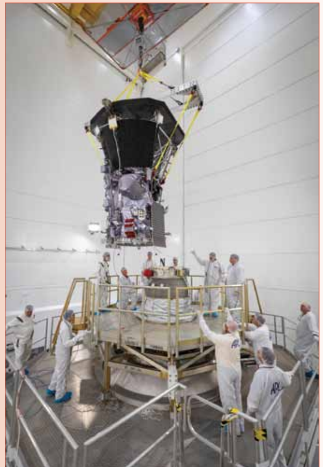
De Parker Solar Probe wordt op de derde trap van de Delta-4 Heavy geïntegreerd. Bovenaan is het hitteschild te zien dat de sonde tegen de Zon moet beschermen. [NASA/Johns Hopkins APL/Ed Whitman]
