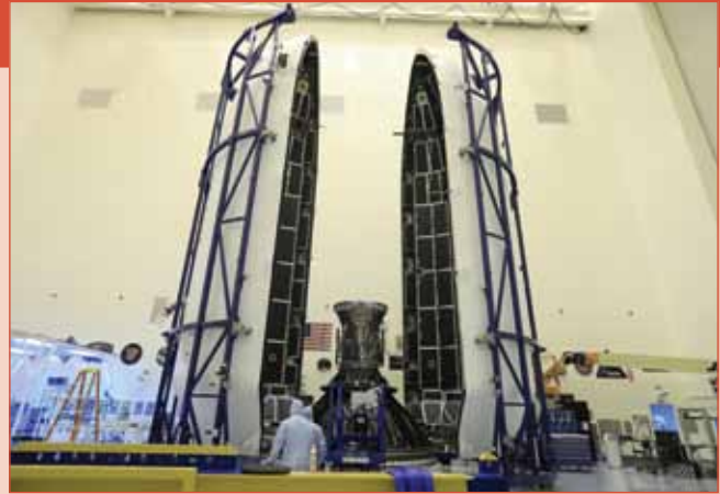
"One size fits all" – de standaard neuskap van de Falcon-9 raket is met 13,5 meter net een maatje te groot voor de 1,5 meter hoge TESS satelliet. [NASA]
