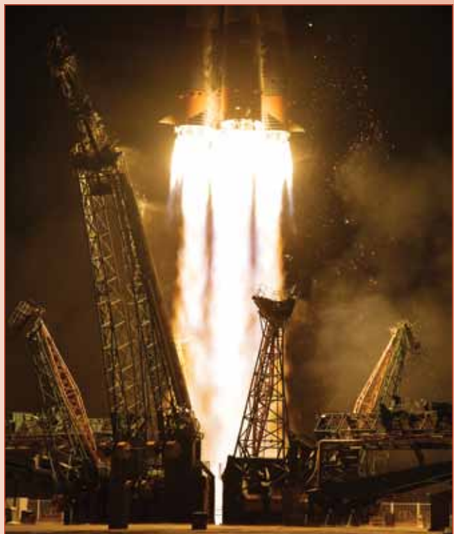
Close-up van de motoren van de eerste en tweede trap tijdens het vertrek van de Soyuz MS-5. [NASA]
