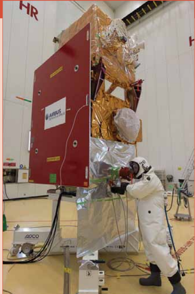
Tijdens de voorbereiding voor de lancering laden technici de hydrazine stuwstof in de tanks van de Sentinel-2B satelliet. [CNES]
