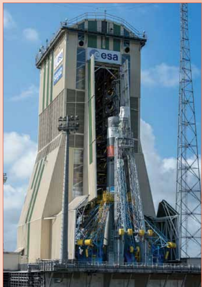
De mobiele integratietoren wordt in positie gebracht rondom de Soyuz raket, voor de installatie van de neuskap met de Hispasat 36W-1 satelliet op de raket. [ArianeSpace]
