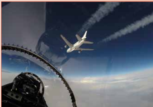
Het gemodificeerde L-1011 vliegtuig met aan de onderzijde de Pegasus raket, kort voor het afwerpen en ontsteken van de eerste trap. [NASA]
