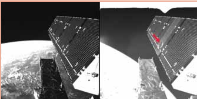
Ruimtevaart is niet zonder risico's zoals deze foto's van de zonnepanelen van Sentinel-1A laten zien. Links een opname kort na de lancering in 2014. Op de foto rechts van augustus 2016 is duidelijk schade aan het paneel te zien als gevolg van de inslag van waarschijnlijk een stukje ruimtepuin. [ESA]
