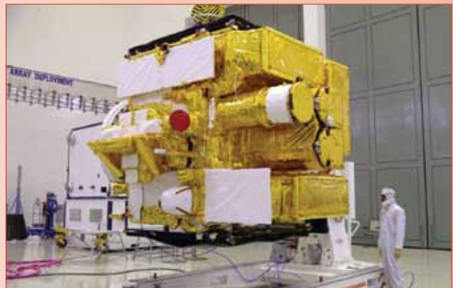
India's eerste sterrenkundige satelliet, Astrosat, tijdens de laatste voorbereidingen in de cleanroom. De cilindrische objecten in het midden van de satelliet zijn de diverse astronomische telescopen. [ISRO]
