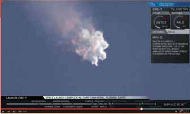
139 seconden na de lancering explodeert de Falcon-9 raket met aan boord de Dragon CRS-7. De bruinige wolk links komt van de negen motoren in de nog steeds functionerende eerste trap, terwijl de witte wolk de stuwstoffen zijn welke uit de falende tweede trap komen. [SpaceX Webcast]
