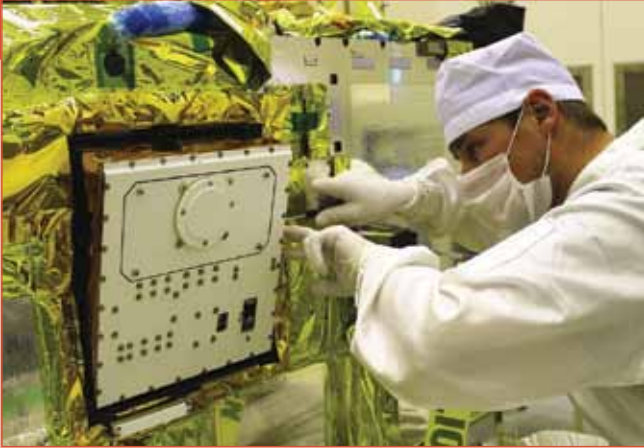
Installatie van het landertje Mascot op de Japanse Hayabusa-2 sonde. In 2018 moet Mascot landen op de planetoïde 1999 JU3. [Foto: DLR]
