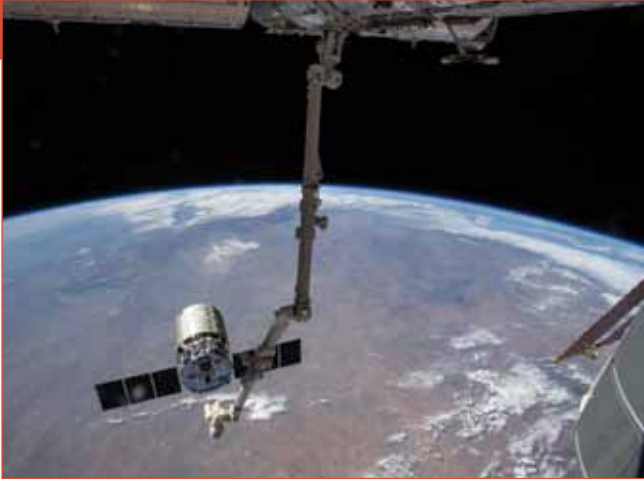
Canadarm-2 staat op het punt de Cygnus CRS-2 aan het ISS te koppelen. [NASA]
