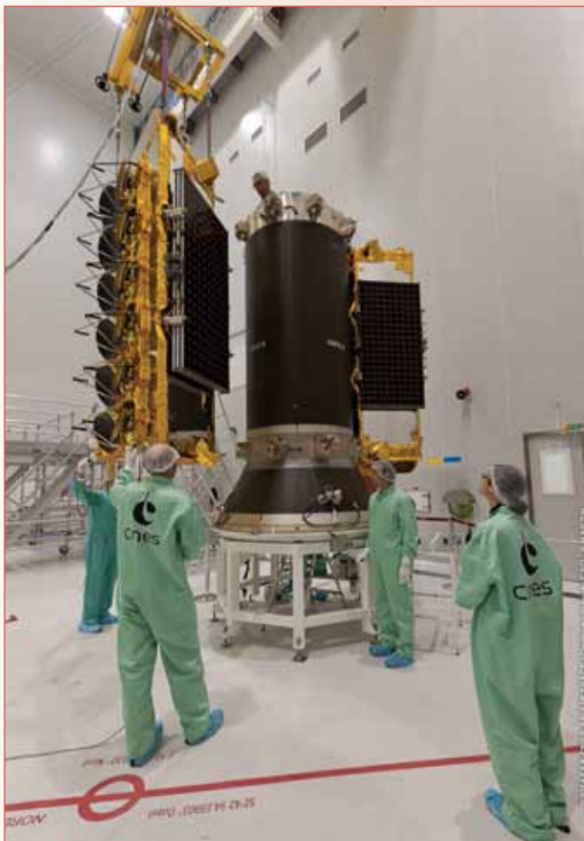
Technici in Kourou, Frans-Guyana, installeren de tweede van vier O3b satellieten op de centrale dispenser. [Arianespace]
