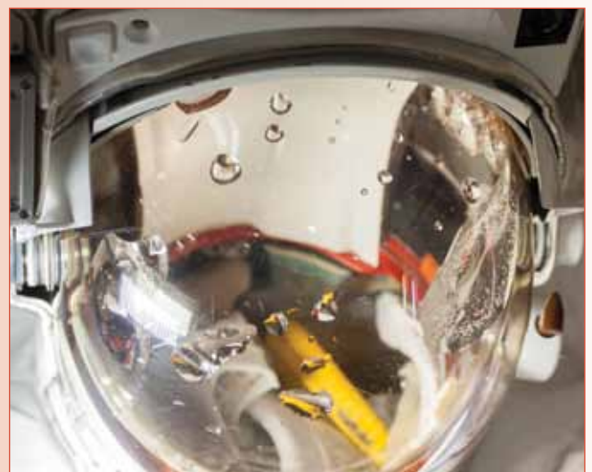
Aan boord van het ISS wordt tijdens een test het lek gereproduceerd in het ruimtepak van Luca Parmitano, dat zorgde voor een voortijdige beëindiging van de ruimtewandeling op 16 juli. [NASA]
