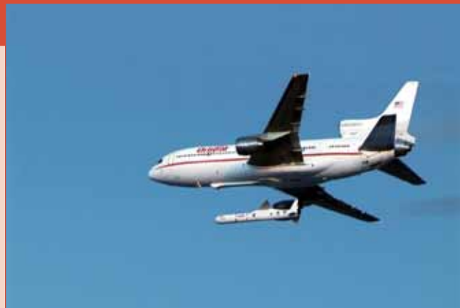
De Pegasus-XL raket met aan boord de satelliet IRIS wordt afgeworpen door het L-1011 draagvliegtuig. Enkele seconden later zou de Pegasus haar motor ontsteken. [NASA]
