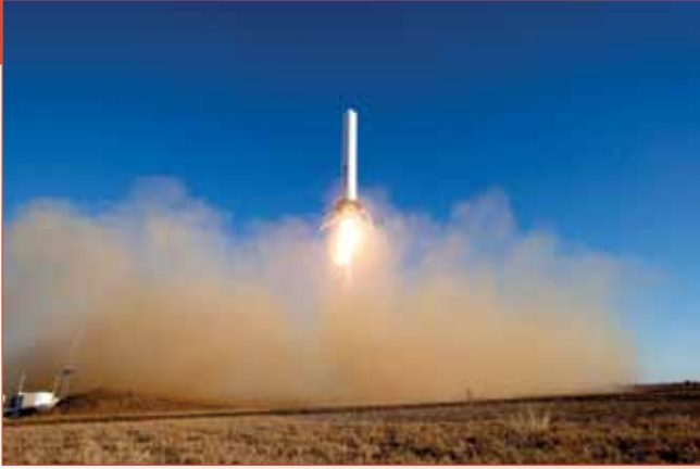
Tijdens een test op 17 december 2012 bereikt een aangepaste eerste trap van de Falcon-9 raket, genaamd Grasshopper, een hoogte van 40 meter alvorens weer verticaal op het lanceerplatform te landen. SpaceX hoopt met deze techniek in de toekomst rakettrappen te kunnen bergen en hergebruiken. [foto: SpaceX]
