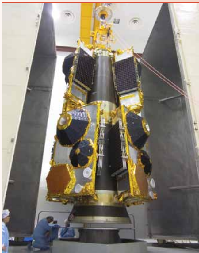
De zes Globalstar satellieten geïntegreerd op de centrale dispenser, alvorens het geheel op de Soyuz raket gemonteerd wordt. [foto: ArianeSpace]
