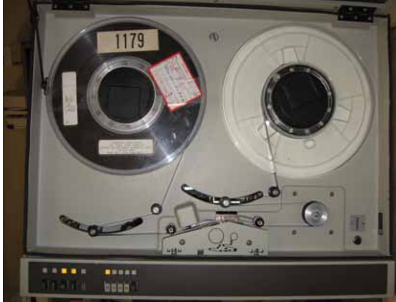
Links: de ITEK luchtverkenningcamera is zichtbaar in het segment van de Service Module van de Apollo-17 waar het zijpaneel eerder van afgevoerd is [NASA]. Rechts: soms kom je op een zoektocht naar oude materialen ook bijzondere en onverwachte zaken tegen. Deze magneetband stond op een verkoopsite in de VS, en bevat geen audio maar computerinstructies om de schakelposities aan te sturen van de Apollo simulatoren waarmee de Apollo-16 bemanning voor hun vluchten trainde. [Niels Haneveld]
