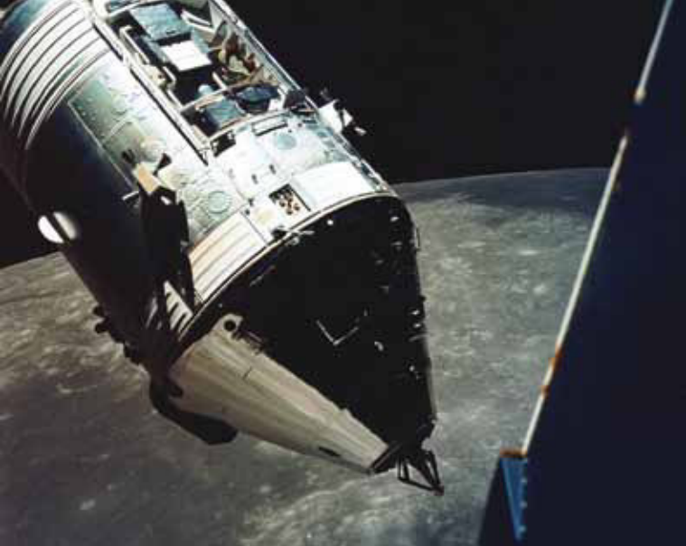
Links: de ITEK luchtverkenningcamera is zichtbaar in het segment van de Service Module van de Apollo-17 waar het zijpaneel eerder van afgevoerd is [NASA]. Rechts: soms kom je op een zoektocht naar oude materialen ook bijzondere en onverwachte zaken tegen. Deze magneetband stond op een verkoopsite in de VS, en bevat geen audio maar computerinstructies om de schakelposities aan te sturen van de Apollo simulatoren waarmee de Apollo-16 bemanning voor hun vluchten trainde. [Niels Haneveld]
