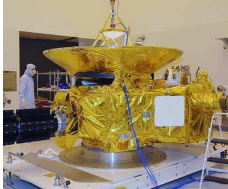
De New Horizons sonde tijdens de laatste voorbereiding voor de lancering. De zwarte cilinder met koelvinnen is een inerte versie van de nucleaire RTG batterij. Vanwege het stralingsgevaar wordt de echte RTG pas op het lanceerplatform gemonteerd. [NASA/KSC]
