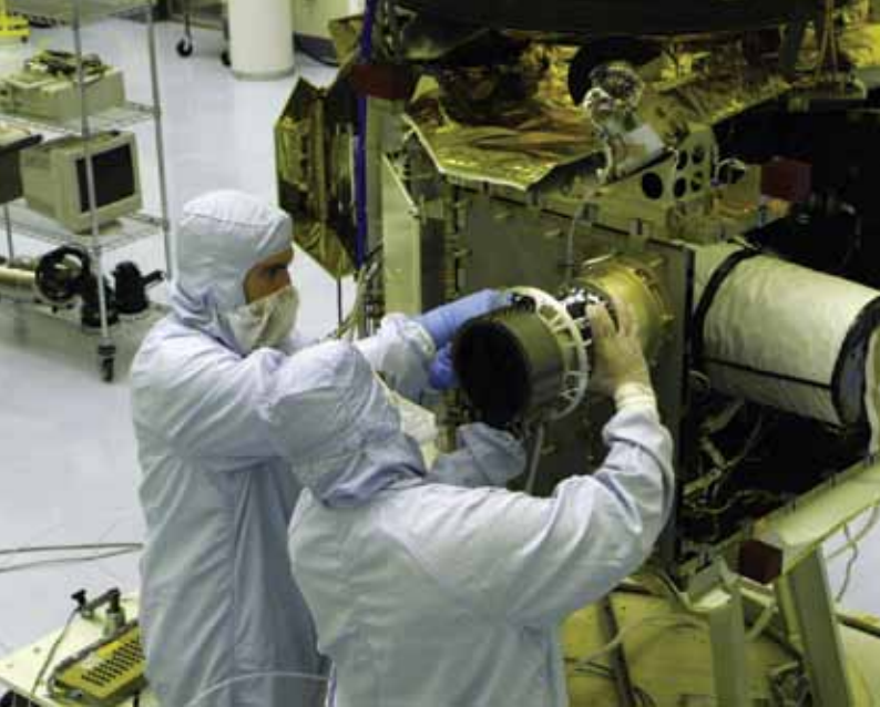
Technici installeren de zonnwinddetector Swap tijdens de integratie van New Horizons. [APL]
