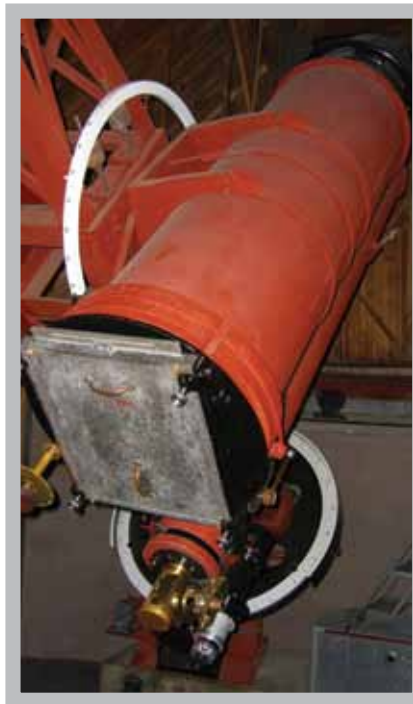
De 13 inch telescoop van Lowell Observatory waarmee Pluto is ontdekt. Het instrument bestaat uit drie achter elkaar geplaatste lenzen die een beeld projecteren op een fotografische glasplaat van 35 bij 42,5 cm. [Lowell Observatory]
