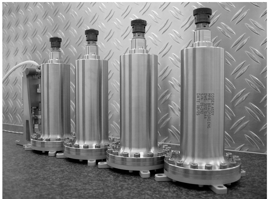
Het complete COGEX vluchtmodel. [Bradford Engineering B.V. & TNO Defensie en Veiligheid]
