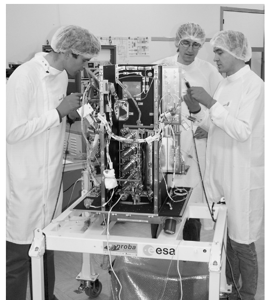
Het complete COGEX vluchtmodel. [Bradford Engineering B.V. & TNO Defensie en Veiligheid]
