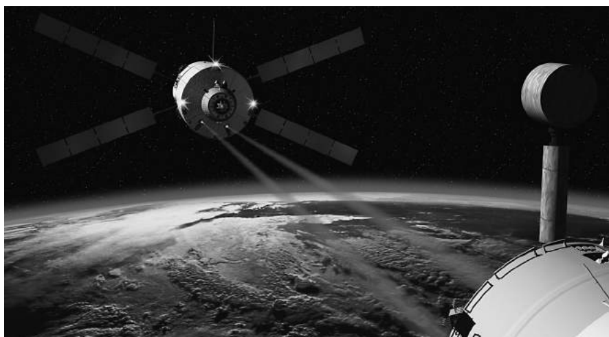
Antennes maken het mogelijk dat de ATV kan communiceren met de Zvezda module gedurende rendez-vous en koppeling. [ESA]
