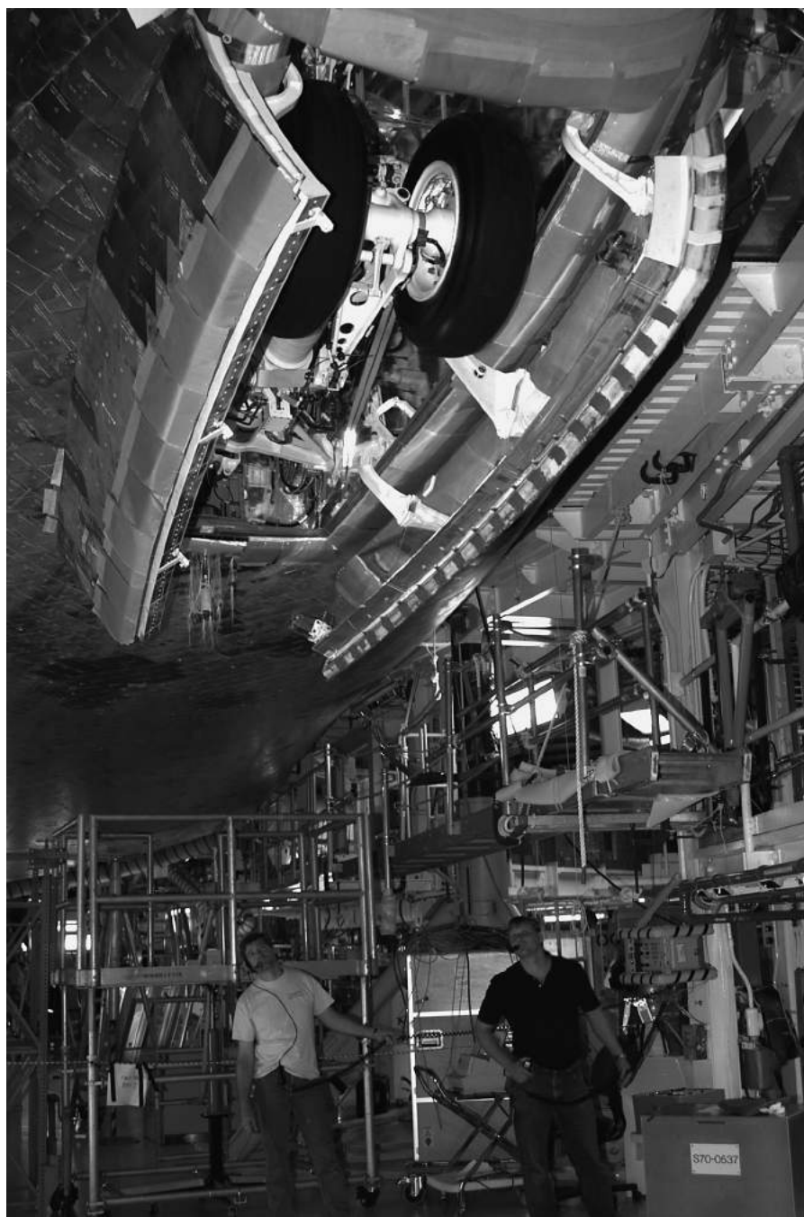
In de Orbiter Processing Facility controleren technici het neus landinggestel van de spaceshuttle Atlantis. Atlantis wordt gereed gemaakt voor de tweede Return-to-Flight missie, STS-121. [NASA]
