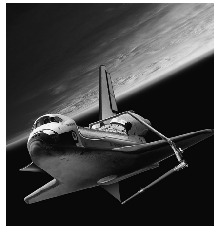
Met de robotarm van de shuttle wordt de inspectiestang OBSS gebruikt om de onderzijde van het hitteschild te inspecteren. [MD Robotics]
