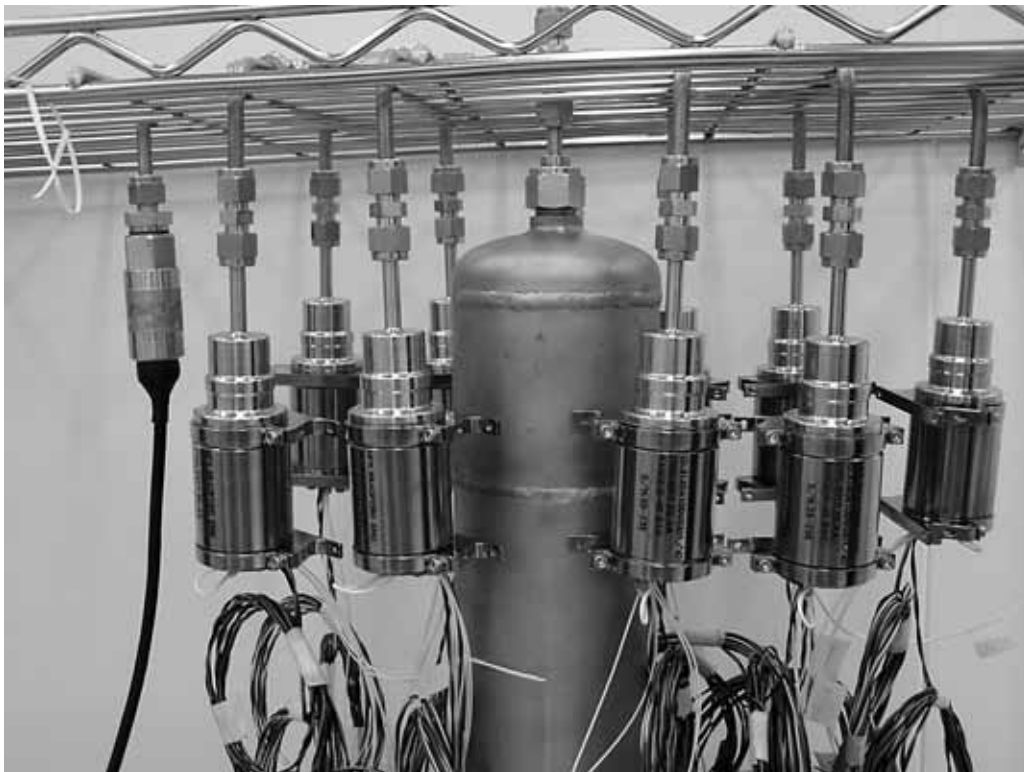
Nauwkeurige calibratie van een serie druk opnemers voor de Planck satelliet. [Bradford Engineering BV]
