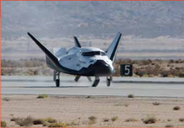
Op 11 november maakt het onbemande ruimtevliegtuig Dream Chaser van Sierra Nevada Corp een succesvolle landing op Edwards. Kort daarvoor werd het toestel op een hoogte van 3700 meter door een helikopter afgeworpen. [NASA/Sierra Nevada]
