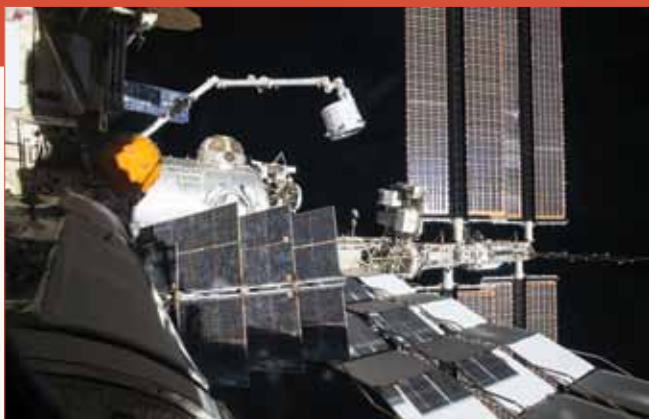
De experimentele opblaasbare module BEAM van het Amerikaanse bedrijf Bigelow wordt hier door de robotarm naar de koppelpoort op Node 3 gemanoevreerd. Later zal de module bij wijze van experiment worden opgeblazen zodat het interne volume sterk vergroot wordt. [NASA]
